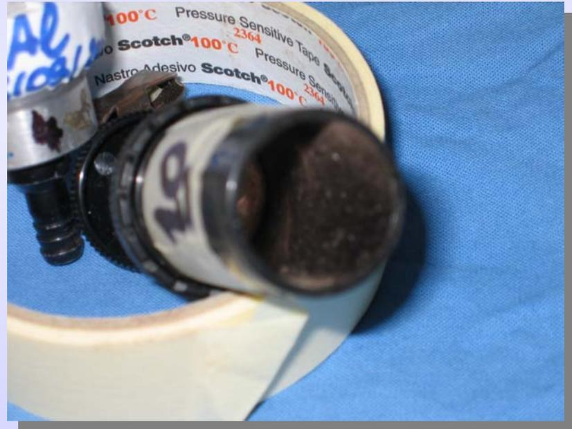
*Deposizione polvere/fibre nei cappucci*
