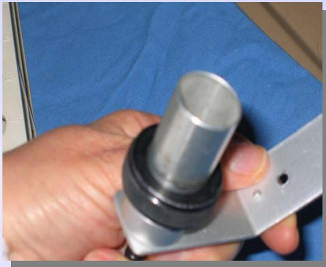
dopo il prelievo, si nota che il cappuccio, di cui è previsto l'uso in tutte le metodiche di prelievo di fibre, presenta impolveramenti dovuti a deposizioni lungo le pareti interne...
